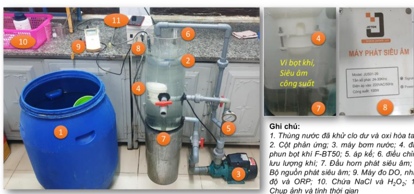
Hình 1. Bố trí thí nghiệm tăng thế oxy hóa của nước bằng kỹ thuật tích hợp MBs, siêu âm công suất và H 2 O 2 .
